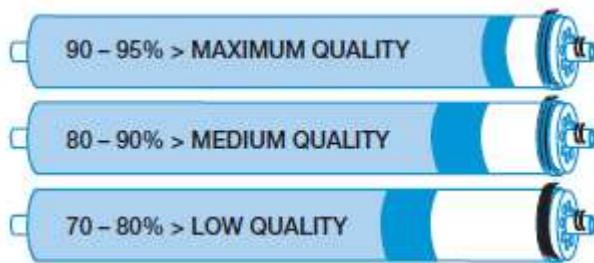
Sub 70%, durata de viata a membranei este terminata. Prin utilizarea unui TDS metru, procentul de saruri eliminate se calculeaza astfel:
